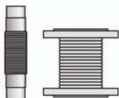
Антивибрационная вставка представляет из себя гофрированный участок трубопровода который устанавливается между газовой рампой и подающим газопроводом и служит для снятия вибрации, которая передается от работающего вентилятора горелки на подающий газопровод. Антивибрационная вставка не входит в стандартный комплект поставки газовой рампы и поставляется по отдельному заказу.
