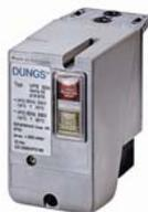
Блок контроля герметичности клапанов является дополнительным элементом безопасности. Блок может быть установлен на газовую рампу, если он отсутствовал в стандартной комплектации. Блок контролирует герметичность предохранительного и регулировочного клапанов рампы в тот момент, когда эти клапаны находятся в закрытом состоянии. Проверка осуществляется после каждой остановки и перед каждым запуском горелки. В случае обнаружения утечки горелка блокируется до выяснения причины.
