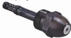
В горелках серии **RL/M BLU** используется специальная форсунка с игольчатым клапаном. Форсунка выбирается в зависимости от максимального требуемого расхода топлива через горелку с округлением в большую сторону.
